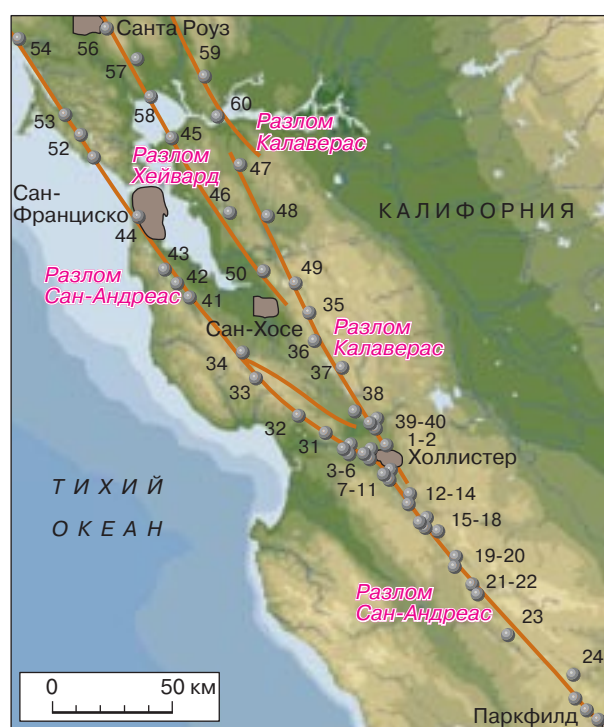
Рис. 1. Схема радонового мониторинга в эксперименте Геологической службы США, 1977–1984 годы. Красным цветом указаны основные разломы: Сан-Андреас, Хейвард и Калаверас. Черными кружками показаны измерительные станции, цифры обозначают номера станций
